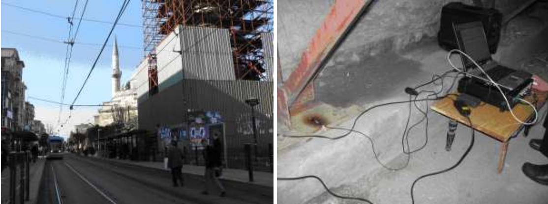
Şekil 2 Çemberlitaş Sütunu temelinde zemin titreşim ölçümü.
