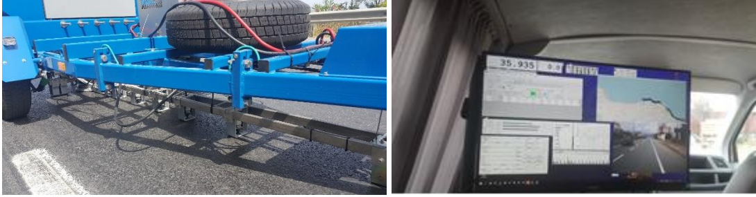
Şekil 3. Dynatest HWD test sistemi yük hücresi, jeofonlar ve ölçüm bilgisayarı
