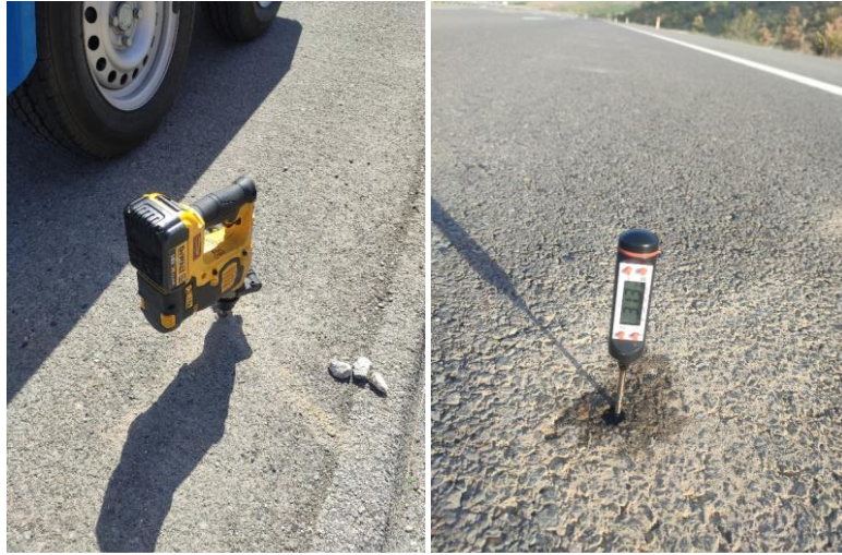
Şekil 7. Asfalt sıcaklığının tespit edilmesi
