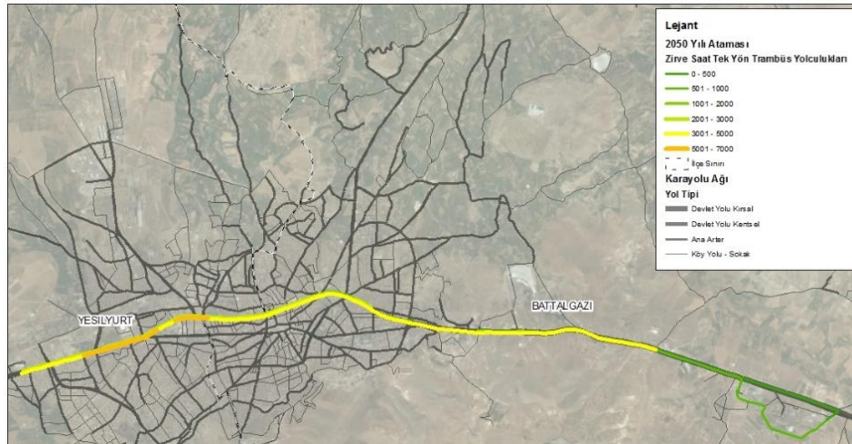
Şekil 2.1 : 2050 yılı Trambüs Hattında Link Üzerinden Geçen Zirve Saat Tek Yön Kesit Trambüs Yolculuğu değerleri
