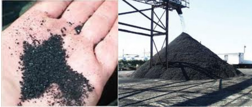
Şekil 2. Öğütülmüş atık araç lastiği (crumb rubber) [15].
