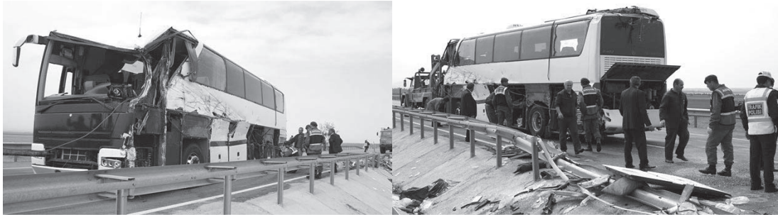
Şekil 1 Kanal içerisine çakılan otokorkuluğa çarpan otobüs.
