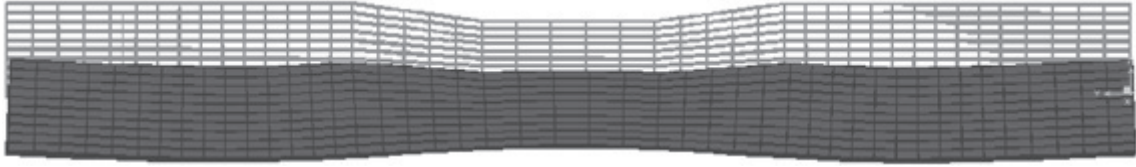
Şekil 4 Tekerlek yüklerine maruz kalmış, balast tabakası tarafından desteklenen traversin 100 kat büyütülmüş şekil değişimi (Bezgin, 2008).
