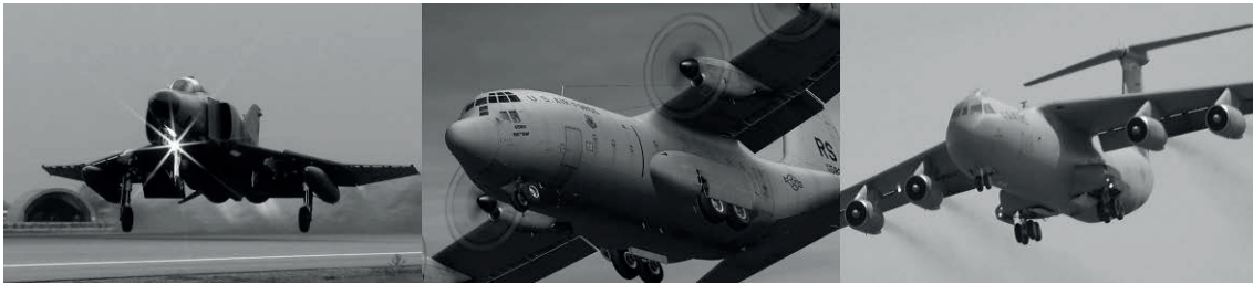
Şekil 2 Farklı tekerlek ve iniş takımı düzenleri: F-4 (S), C-130 (2S), C-141 (2D).
