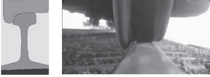
Şekil 2 Tren teker budeni ile ray irtibatının temsili ile profil resmi (Samuels, 2008).
